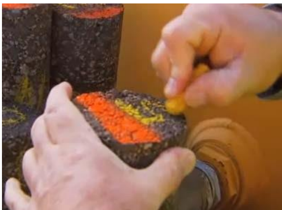
Figura 758 - 5. Identificación un núcleo de pavimento
