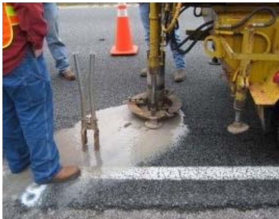
Figura 758 - 4. Ejemplo de dispositivo para extraer un núcleo de pavimento
